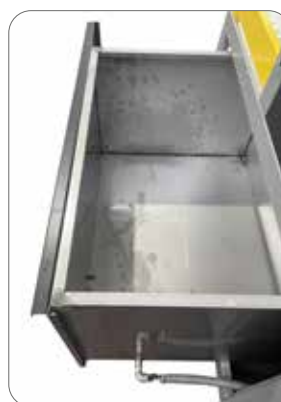
Depósito de acero inoxidable para la recogida del agua limpia
